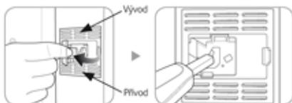
2. Užijte navlhčený vatový tampon k vyčištění čoček, otřete prach z přívodu a vývodu vzduchu a znovu otřete a zbavte vlhkosti pomocí suchého vatového tamponu.
