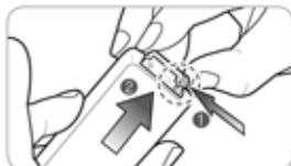
1. Tlačení posuňte „háček“ zásobníku baterií dole na zadní části dálkového ovládání ve směru 1 a současně vytáhněte zásobník baterií ve směru 2.
