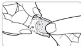
2. Vložte izolovanou baterii ve vhodné pozici do zásobníku baterií podle znaménka plus na „háčku“.
