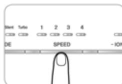
4. Zvolte požadovaný stupeň senzoru a současně stiskněte tlačítka rychlosti a režimu po dobu 2—3 vteřin. Zobrazující panel shrně normální operace a stupeň senzoru se zobrazí následně.
